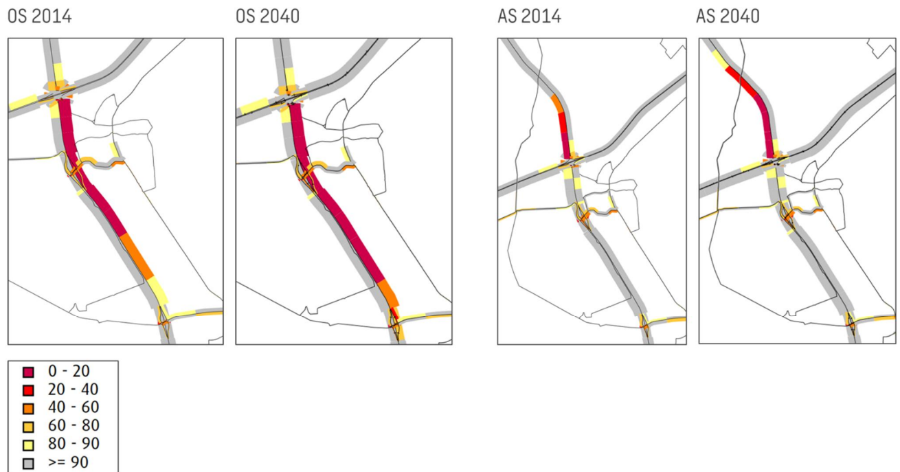
Figuur 4.9 Verkeersafwikkeling rond verkeersplein Gieten. De kleuren laten zien welke snelheid wordt gerealiseerd (paars/rood is lage snelheid).
